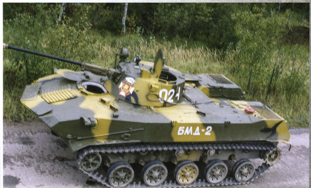
Боевая машина десанта БМД-2, вид сверху. Хорошо виден открытый люк механика-водителя.
